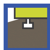
COSTRUZIONE ADERENTE AL SUOLO CON FONDAZIONI CONTINUE
