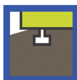
COSTRUZIONE ADERENTE AL SUOLO CON FONDAZIONI CONTINUE
