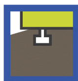
COSTRUZIONE ADERENTE AL SUOLO CON FONDAZIONI CONTINUE
