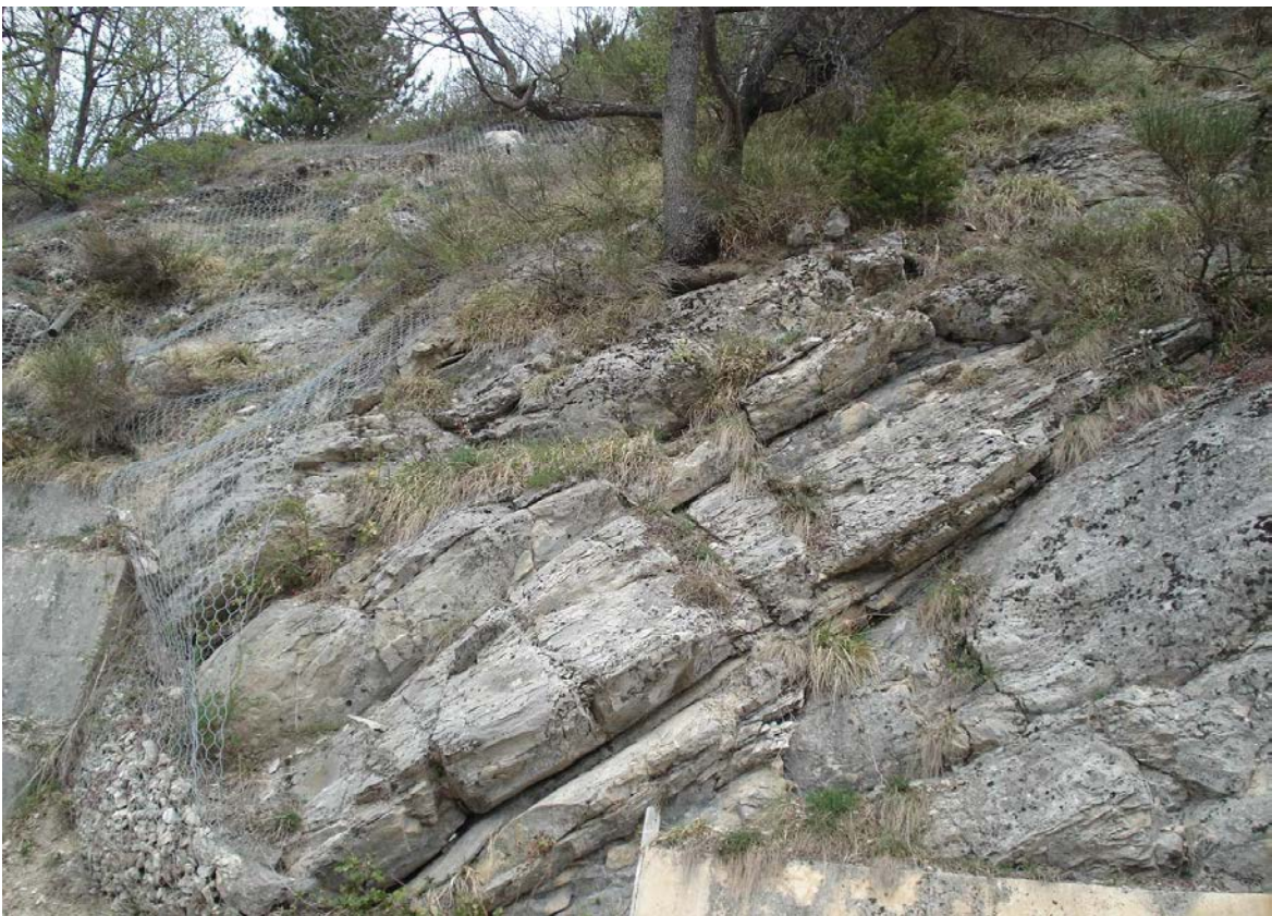
Fig. 20 - Colle Piano. Zona di confine tra le litofacies marnoso-calcareitica (CRRa) e calcarenitico-calciruditea (CRRb) delle Marne con cerroigna , con J_v < 10 .
